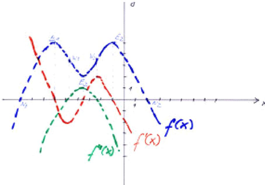
1. Die Ausgangsfunktion  $f(x)$  hat drei Extrema (E1 Maximum, E2 Minimum und E3 Maximum) sowie zwei dazwischenliegende Wendepunkte W1 und W2. Die beiden Nullstellen N1 und N2 sind für die Ableitungsskizze nicht wesentlich.
